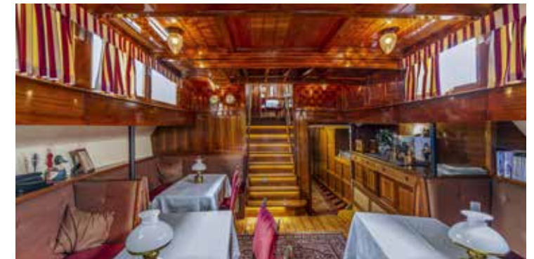
Lustjakten MS Arona byggdes år 1904 för punch-kungen Edward Cederlund den yngre. De senaste åren har båten genomgått en genomgripande renovering. På bilden syns ny överbyggnad, invändig lejdare, invändig och utvändigt aktersoffa. Linjon har haft huvudansvaret för arbetet, från idé via tillverkning till slutmontering.
